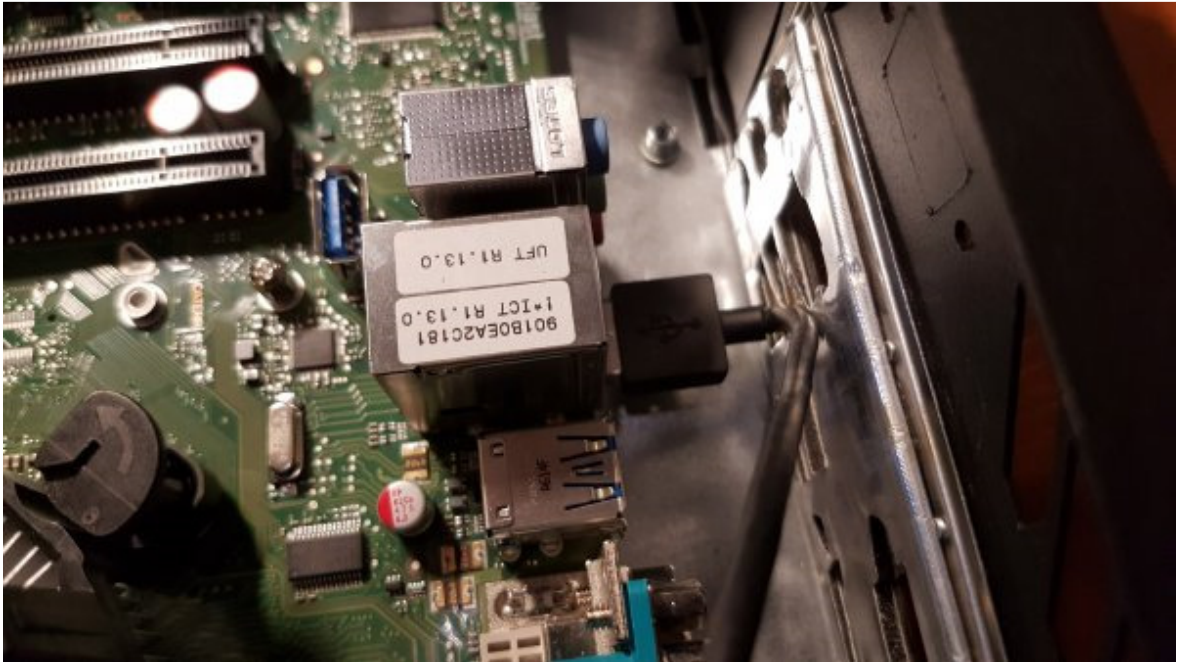
Fot. 11 – Kabel USB podłączony do „zaślepionego” portu USB (po zdemontowaniu płyty głównej)
