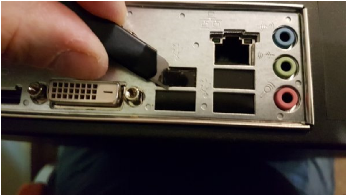
Fot. 14 – Usunięcie zaślepienia portu USB
