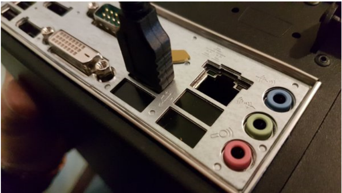
Fot. 16 – Podłączenie myszy komputerowej do odsłoniętego portu USB
