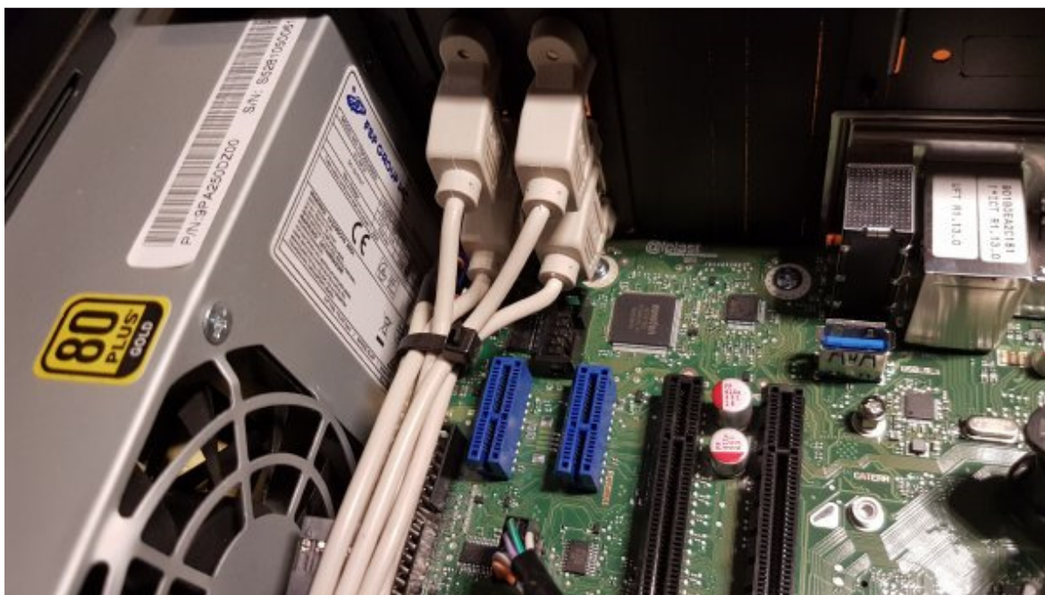
Fot. 9 - Cztery porty USB 2.0 na tylnym panelu zamontowane przy użyciu połączenia kablowego z płytą główną
